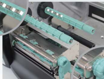
破帶內外卷自動切換設計 安裝方便、使用簡單
